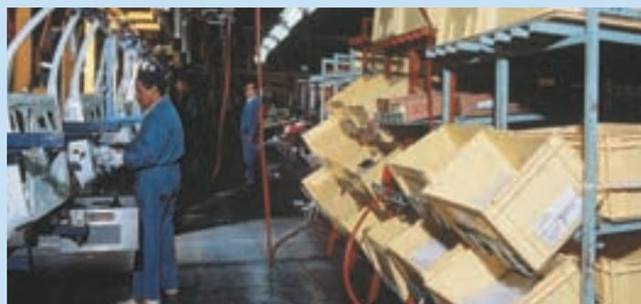
Protection des pièces et propreté des bords de ligne (bacs Odette 20 kg).
