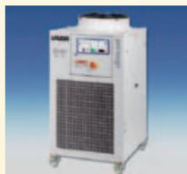
Les refroidisseurs industriels LAUDA Ultracool, offrant une puissance de réfrigération pouvant atteindre 265 kW et opérationnels sur une gamme de température de -5 à 25 °C, sont utilisés notamment pour assurer le refroidissement des machines
