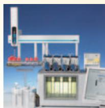
Les viscosimètres et tensiomètres LAUDA sont indispensables pour l'analyse de polymères, huiles, graisses et tensioactifs. Le concept modulaire du viscosimètre de process PVS permet de réaliser des mesures
