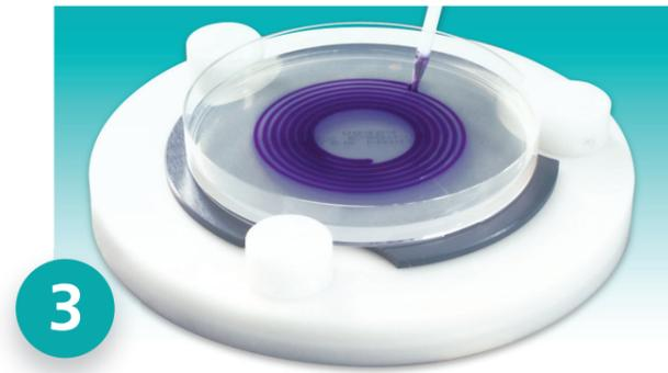
3 La boîte d'agar tourne et la seringue distribue automatiquement le volume précis sur la boîte et dessine une spirale avec l'échantillon déposé.
